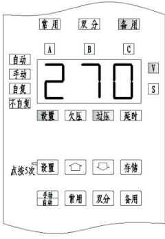
图四 进入备用电源过压参数整定时的显示状态 （无关指示灯没有示意状态）
