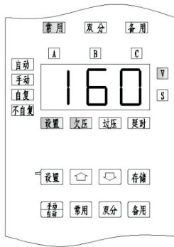
图三 第一次点按“设置”后的显示状态
