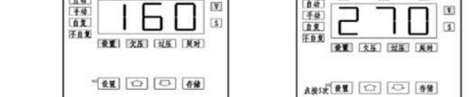
图九 进入备用电源欠压参数调整时的显示状态(无关指示灯没有意义状态)
